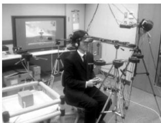
ゲーム内の動作と連携して現実の世界で風を発生させ臨場感を高めるシステム。キャラクターの移動（歩く、走る、方向転換）によって風を発生させる。また、環境
