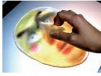
PhotoelasticTouch は透明フルで作られた 3 次元オブジェクトに対する、直感的な対話を実現するインタラクティブデバイスである。このシステムは、透明弾性体に対する押し戻り感や引っ張りといったユーザの接触動作を、LCD の偏光と光弾性を用いることで、リアルタイムに検出することができる。また、様々な形状の弾性体を利用することが可能で、LCD 上に表示されるコンテンツに合わせた、豊かな 3D 形状もった透明インタフェースを容易に実現することができる。
