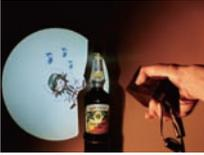
Twinkle は小型のプロジェクタを使用した AR インタフェースです。プロジェクタで照らした物体をカメラによって認識し、物体の形状や色、及びプレイヤーの動きに応じた音や映像をリアルタイムに生成します。プレイヤーは手に持ったプロジェクタで投影されたキャラクターを操作し、ホワイトボードに描いた絵の上を歩かせたり、手で行く手を遮ったりといった様々なインタラクションを楽しむことができます。AR マーカーやモーションキャプチャ装置は必要なく、机や壁や床といった様々な場所に投影できます。
