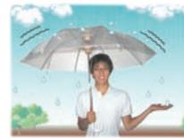
雨と人をつなぐインタフェースである傘に注目し、雨を再現して体験できる傘型デバイス「Funbrella」を実現した。傘を通じて雨を知覚する要素として、今回は手元に伝わる振動に注目し、ダイナミック・スピーカの構造を利用して、実際の雨が傘にあたる振動を記録、再生できる機構を実装した。ユーザは Funbrella を用いて日常では体験できない奇妙な「雨」を体験するアプリケーションや遠隔地間で電話のように雨の情報を共有できるアプリケーションを体験できる。
