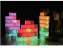
Bloxel とは、Block とディスプレイの基本要素を意味する Pixel の融合を意味する造語です。Bloxels では、手で積み上げることで簡単にディスプレイ間の光通信路を構築することができます。さらに、この通信路を用いてそれぞれのブロックのカラーデータを転送することで各ブロックが発光し、ブロック全体として一つのディスプレイを形成します。
