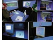
壁型ディスプレイ、机の上のディスプレイ、PC やノート PC など、部屋中のディスプレイを、あたかも一つの GUI 環境であるかのようにシームレスに接続して利用するための環境とインタフェースを提案します。利用者からは常に情報を正対して見ることができるようにパースペクティブに表示し、複数のウィンドウに跨る場合も切れ目なく表示され、ポイントも複数のウィンドウの間をシームレスに移動します。
