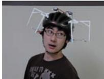
本作品は触覚を用いたナビゲーション装置である。触覚における最も直観的なナビゲーション方法は目的地へ手を取って案内する、つまり腕を牽引することが挙げられるが、そこには大きなエネルギーが必要となる。我々は腕の牽引と同様の直観的かつ簡便な性質を持つ触覚歩行誘導手法として、耳の牽引を用いる。耳は手を引く場合と比べて少ないエネルギーで頭部が傾き、誘導が可能となる。
