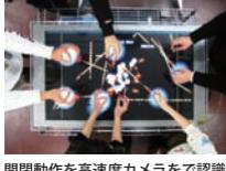
PAC-PAC は多人数で同時に遊ぶことができるテーブルトップエンタテインメントシステムである。このシステムでは大型液晶ディスプレイをテーブルとして用い、その上での指の開閉動作を高速度カメラで認識する。複数人の手の位置と向きを同時に入力することができる、タッチパネルでのタッチ入力よりも自由度の高い入力を楽しむことができる。今回の展示では同システムを利用したシューティングゲームを展示する。ディスプレイの上で手をバクバクと動かすことで、好きな位置から好きな向きに弾を打つことができるので、協力して敵を倒したり、二組に分かれて対戦ゲームを楽しむことができる。
