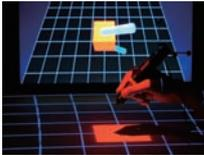
Pen de Touch は、バーチャルな物体に接触した力を提示する触覚ディスプレイであり、ペン型のデバイスを用いて様々な物体に接触した感覚を再現することができます。体験者は、デバイスを持って空間中で手を動かすことで、画面上に表示されたバーチャルな物体を触って感覚を楽しんだり動かして遊んだりすることができます。
